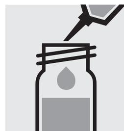
Aggiungere 0,50 ml di campione con pipetta, chiudere la cuvetta con tappo a vite e mescolare.
