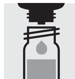
Aggiungere 5 gocce di **AOX-4**, chiudere con tappo a vite e mescolare. Lasciare sedimentare il carbone. soluzione sovranatante: **campione preparato**
