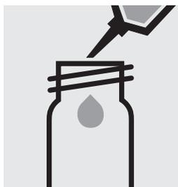
Pipettare 5,0 ml di campione in una cuvetta rotonda.
