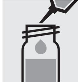
Pipettare 5,0 ml di campione in una cuvetta di reazione, chiudere la cuvetta con tappo a vite e mescolare.
