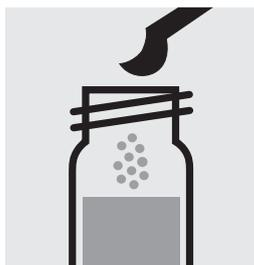
Aggiungere 1 microcucchiaino raso giallo di **N-3K** nella cuvetta di reazione, chiudere la cuvetta con tappo a vite.
