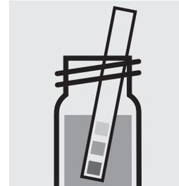
Controllare il pH del campione. Risultato necessario: pH 3,0. Se necessario correggere il pH aggiungendo goccia a goccia una soluzione diluita di idrossido di sodio o di acido solforico.
