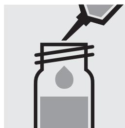
Pipettare 5,0 ml di campione in una cuvette di reazione, chiudere con tappo a vite e mescolare.
