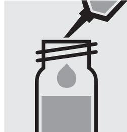
Pipettare 0,20 ml di campione in una cuvetta di reazione, chiudere con tappo a vite e mescolare.
