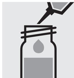
Aggiungere 5,0 ml di acqua distillata (si consiglia Acqua per analisi EMSURE®, art. 116754) con pipetta, chiudere con tappo a vite e mescolare.
