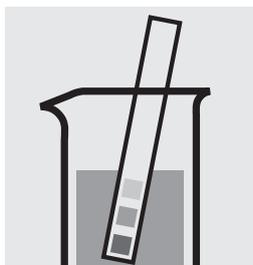
Controllare il pH del campione. Intervallo necessario: pH 4–10. Se necessario correggere il pH aggiungendo goccia a goccia una soluzione diluita di idrossido di sodio o di acido solforico.
