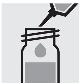
Pipettare 3,0 ml del campione agitato in una cuvetta di reazione.
