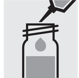
Aggiungere 0,20 ml di **reattivo 2** con pipetta. Chiudere la cuvetta con tappo a vite e mescolare.
