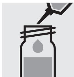
Pipettare 1,0 ml del **campione preparato** pretrattato in una cuvetta, **non mescolare!**
