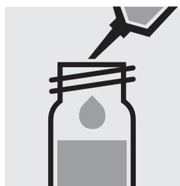
Pipettare 5,0 ml di campione in una provetta con tappo a vite. **(Importante: non usare provette di vetro contenente boro!)**
