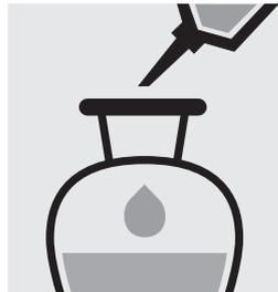
Aggiungere 10 ml di cloroformio con pipetta, chiudere per bene l'imbuto separatore.
