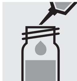
Aggiungere 3,0 ml di campione con pipetta, chiudere la cuvetta con tappo a vite e mescolare.
