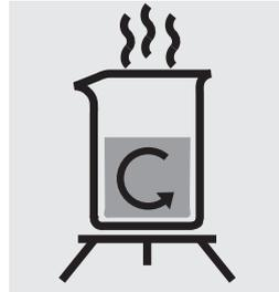
Fare evaporare quasi fino ad essiccazione 200 ml di soluzione campione in un becher collocato sulla piastra di riscaldamento.
