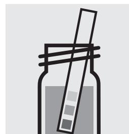
Controllare il pH. Intervallo necessario: pH 12–13. Se necessario correggere il pH aggiungendo goccia a goccia una soluzione diluita di idrossido di sodio.
