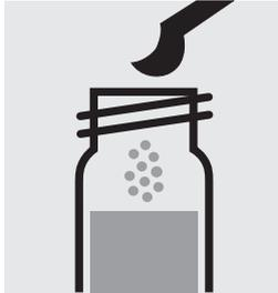
Mettere 1 microcucchiaino raso giallo di NO<sub>3</sub>-1K in una cuvetta di reazione e chiudere.
