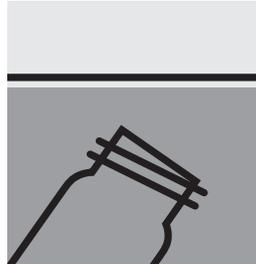
Immergere completamente una cuvetta di reazione dentro al campione acquoso da analizzare, evitando la formazione di bolle d'aria all'interno della cuvetta.
