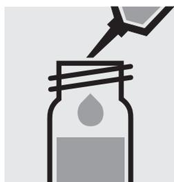
Pipettare 2,0 ml di campione in una cuvetta di reazione, chiudere con tappo a vite e mescolare.
