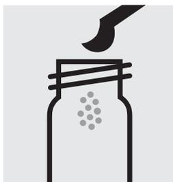
Mettere 1 microcucchiaino raso blu di NO<sub>3</sub>-1 in una cuvetta rotonda vuota ed asciutta (cuvette vuote, art. 114742).
