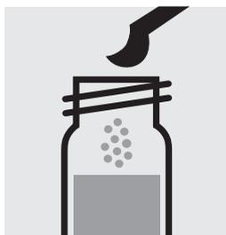
Mettere 1 micro-cucchiaino raso verde di **HCHO-1K** in una cuvetta di reazione, chiudere con tappo a vite.
