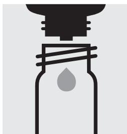
Aggiungere 6 gocce di **Cr-3K** nella cuvetta di reazione e chiudere la cuvetta con tappo a vite.
