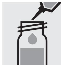
Aggiungere 5,0 ml di **campione preparato** con pipetta, chiudere la cuvetta con tappo a vite e mescolare.
