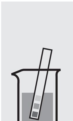
Controllare il pH del campione. Intervallo necessario: pH 6–7. Se necessario correggere il pH aggiungendo goccia a goccia una soluzione diluita di idrossido di sodio o di acido nitrico.
