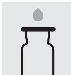
Riempire fino al limite del traboccamento 2 flaconi di reazione ossigeno con la **soluzione di sali nutritivi inocolata** e con 2 perle di vetro. Chiudere i flaconi con i rispettivi tappi di vetro obliqui evitando la formazione di bolle d'aria.
