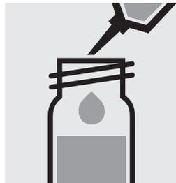
**Lentamente** pipettare 1,0 ml di campione nella cuvetta di reazione. Chiudere bene e mescolare con forza. **Attenzione: la cuvetta diventa calda!**
