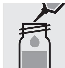
Aggiungere 5,0 ml di **OA-5** con pipetta, chiudere la cuvette con tappo a vite e agitarla con forza.
