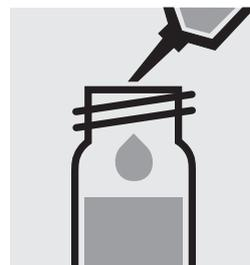
Aggiungere 5,0 ml di campione con pipetta, chiudere la cuvetta con tappo a vite e mescolare.
