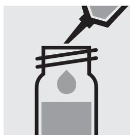
Aggiungere 0,50 ml di **OA-4** con pipetta, chiudere la cuvette con tappo a vite e mescolare.
