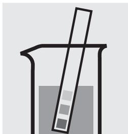
Controllare il pH del campione. Intervallo necessario: pH 3–8. Se necessario correggere il pH aggiungendo goccia a goccia una soluzione diluita di idrossido di sodio o di acido solforico.
