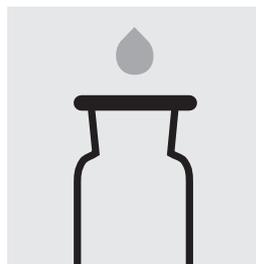
Riempire fino al limite del traboccamento 2 flaconi di reazione ossigeno con il **campione preparato** e con 2 perle di vetro. Chiudere i flaconi con i rispettivi tappi di vetro obliqui evitando la formazione di bolle d'aria.
