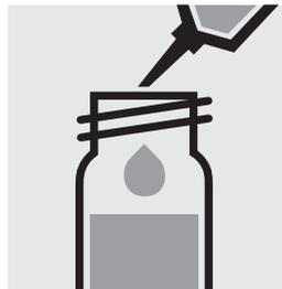
Pipettare 0,10 ml di campione in una cuvetta di reazione, chiudere con tappo a vite e mescolare.
