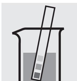
Controllare il pH del campione. Intervallo necessario: pH 2–10. Se necessario correggere il pH aggiungendo goccia a goccia una soluzione diluita di idrossido di sodio o di acido solforico.
