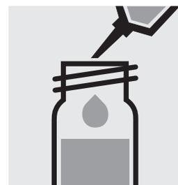
Aggiungere 5,0 ml di **Zn-6** (art. 106146, isobutilmetilchetone) con pipetta e chiudere bene la provetta con tappo a vite.
