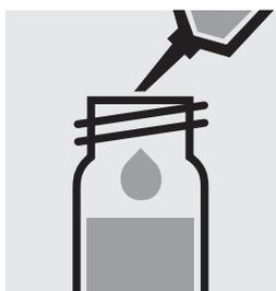
Pipettare 0,20 ml di **AOX-1K** in una cuvetta di reazione e mescolare.
