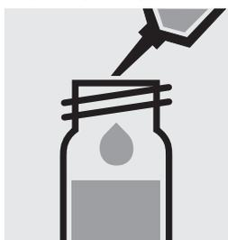
Aggiungere 7,0 ml di acqua distillata in la seconda cuvetta di reazione, chiudere con tappo a vite e mescolare. (Bianco)
