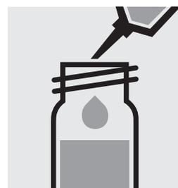
Aggiungere 0,50 ml di **reattivo 2** con pipetta. Chiudere la cuvetta con tappo a vite e mescolare.
