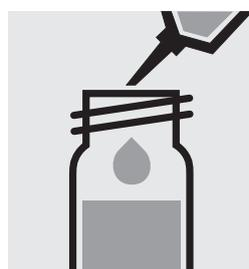
Aggiungere 0,20 ml di **Oxyscav 2** con pipetta, chiudere con tappo a vite e mescolare.
