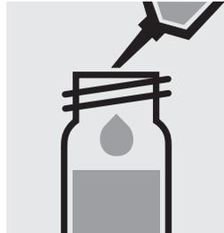
**Lentamente** pipettare 5,0 ml di **campione impoverito** in una cuvetta di reazione. Chiudere bene e mescolare con forza.
