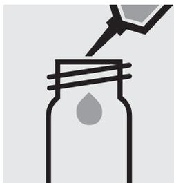
Pipettare 10 ml di campione in una cuvetta rotonda vuota (cuvette vuote, art. 250621).
